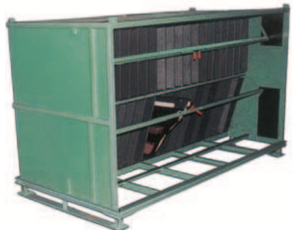
Sonderbehälter der Automobilindustrie zum Lagern und beschädigungsfreien Transport von einbaufertigen Türinnenverkleidungen
