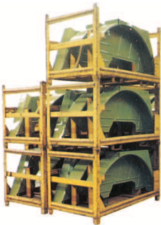
Transport- und Lagergestell für vorgefertigte Teile als Zwischenlager
